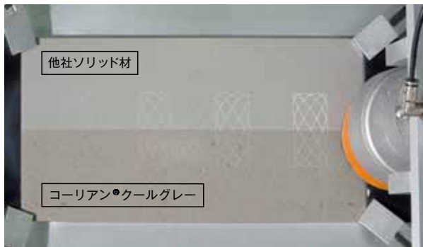
機械を用い4段階の力(写真左から10N、15N、20N、30N)で人為的に擦りキズを施した、再生前の写真。
