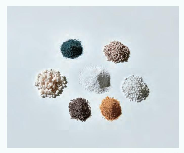
コーリアン"の原料であるメタクリル酸メチル(MMA)に水酸化アルミニウム(ATH)を混ぜると白い液体になる。色をつける場合は顔料(写真下)を、粒目の模様の場合はクランチと呼ばれる粒(写真上)を混ぜる。
